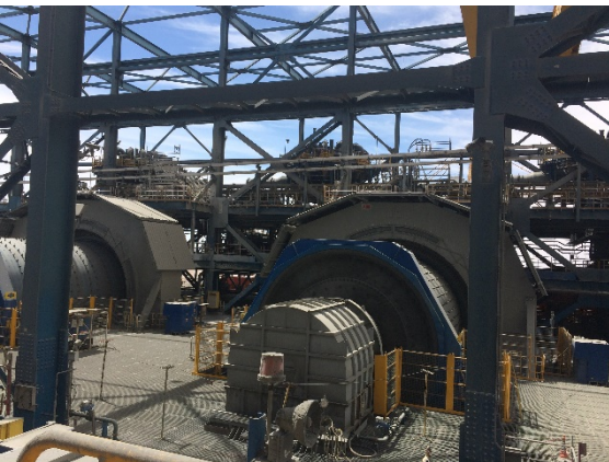
Molinos de bolas utilizados para procesar el mineral en una mina de cobre chilena.
