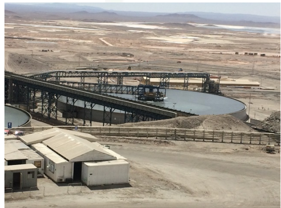
La decantación de residuos de flotación durante la producción de cobre en el norte de Chile.
