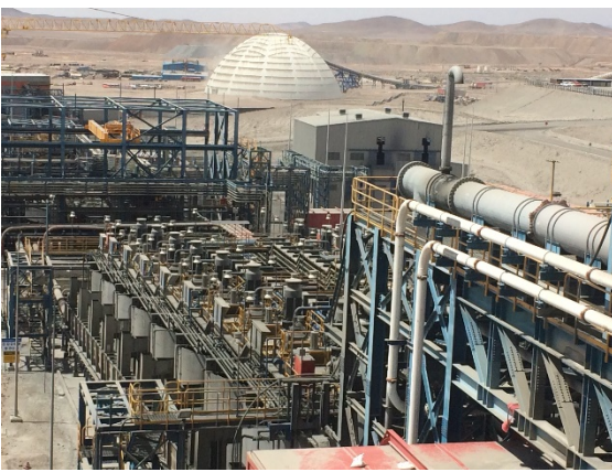
Celdas de flotación utilizadas en una fase preliminar de producción de cobre en Chile.
