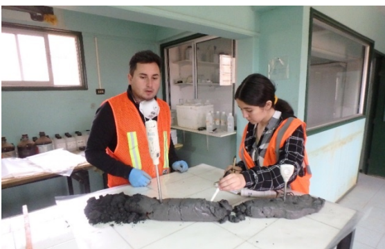
Primer examen en el laboratorio de campaña del material de núcleo perforado de un antiguo depósito de relave en colaboración con los socios de proyecto chilenos
