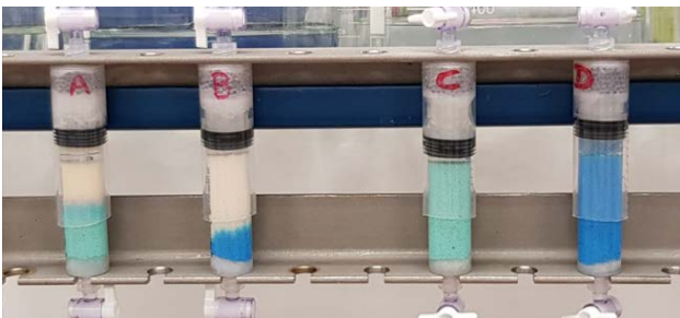
Experimentos de recuperación de cobre y cobalto mediante aguas del lugar con intercambio de iones
