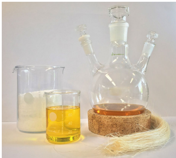
Verwendete Rohstoffe: Lactid, Pflanzenöl und Naturfasern sowie eine Zwischenstufe der Polymersynthese im Reaktionskolben.
