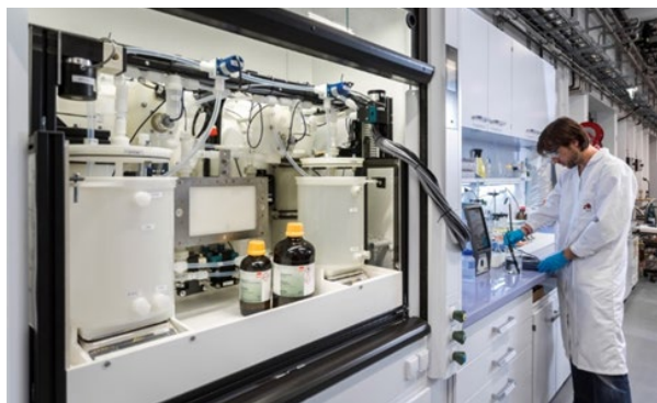
Voruntersuchungen zur Aufkonzentration von geothermalen Solen mit einer Membrandestillations-Testzelle.
