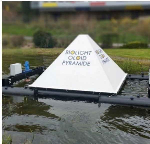
Wasserumwälz-, Sauerstoffanreicherungs- und Entkeimungsanlage für flache, offene Wasserspeicher.
